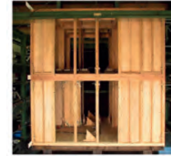
熊本地震級の前震の自身波と本震の地震波を2回加えても倒壊しない事を実証しました。
